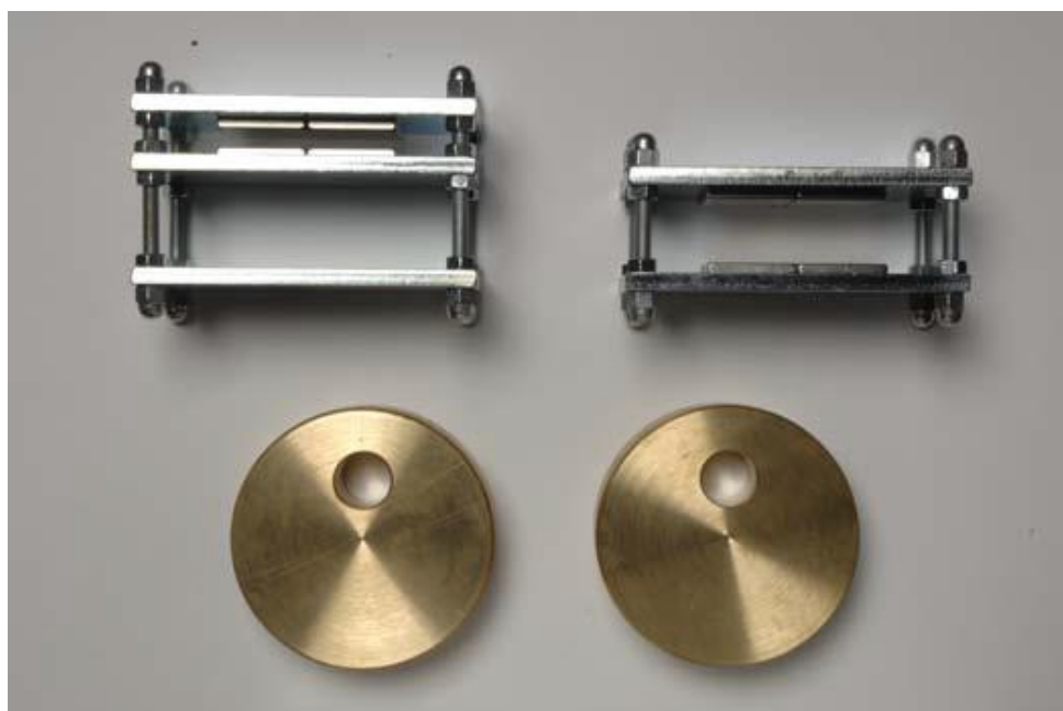
Rândul de sus: magneți de amortizare (stânga) și magneți senzor (dreapta); Rândul de jos: greutateți de alamă.
