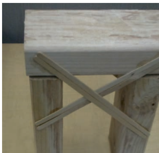
Model din blocuri/piese din lemn unite doar prin elementele de rigidizare încrucișate
