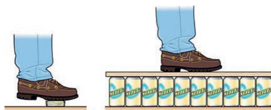
Gradul de deformare depinde de suprafața asupra căreia forța acționează
