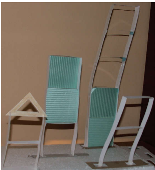
Diverse machete pentru observarea comportării clădirilor la cutremur
