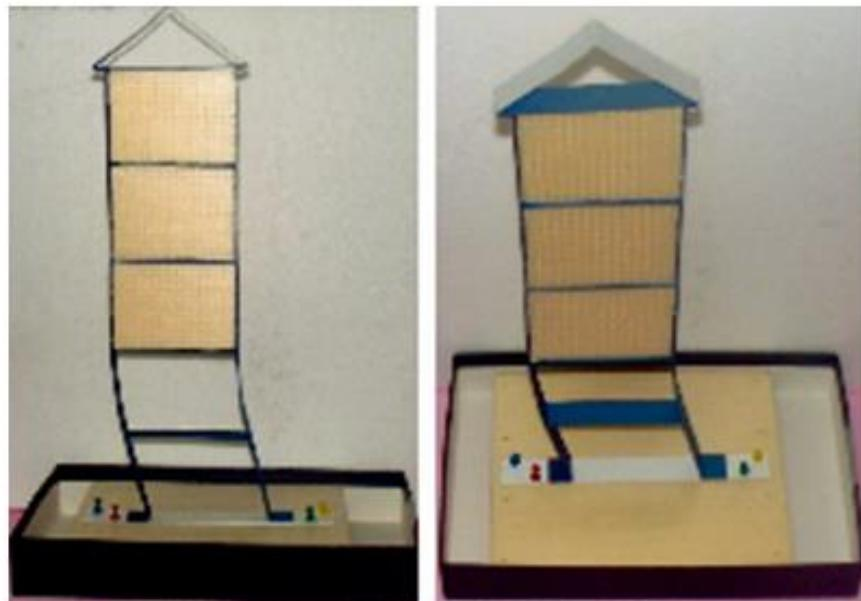
Exemplu de mini-simulator seismic și de modele structurale ce pot fi confectionate utilizând materiale la îndemâna elevilor și a profesorilor.
